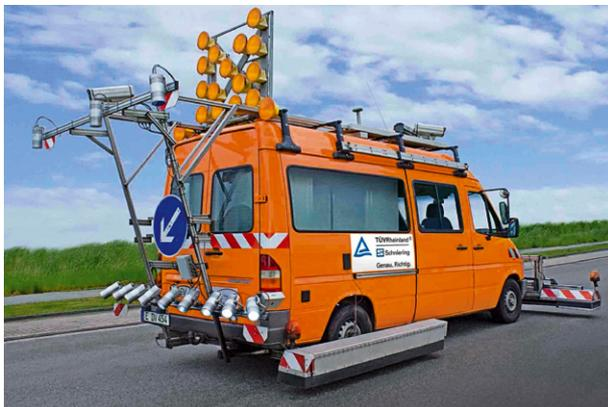
Abbildung 3: ZEB-Messfahrzeug
