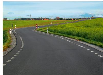
Abbildung 30: Markierung Entwurfsklasse EKL 4 nach RAL
