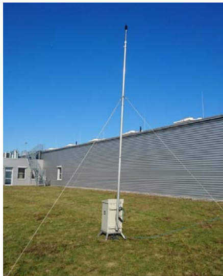
Abb. 1 Mobile Fluglärmmessanlage (Quelle: FLHG)
